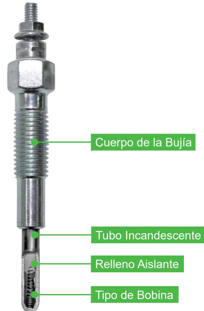
Para cumplir las normas de conformidad de emisiones, se requiere que las bujías incandescentes alcancen la temperatura óptima inmediatamente al arrancar el motor en frío. Un tiempo de espera más corto mejorará la eficiencia de la combustión y reducirá el consumo de combustible.
